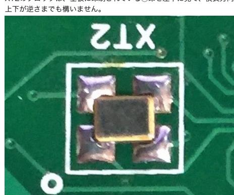
クロックは、フラックスをランドに塗って、クロックをピンセットで少し浮かせて、ハンダ付けしてください。浮かせないと、クロックの底面のランドにハンダが廻りません。
