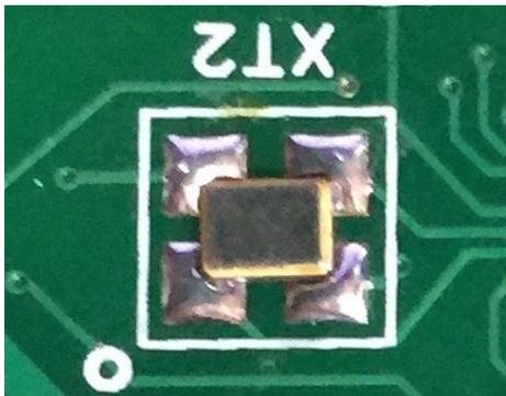
クロックは、フラックスをランドに塗って、クロックをピンセットで少し浮かせて、ハンダ付けしてください。浮かせないと、クロックの底面のランドにハンダが廻りません。
