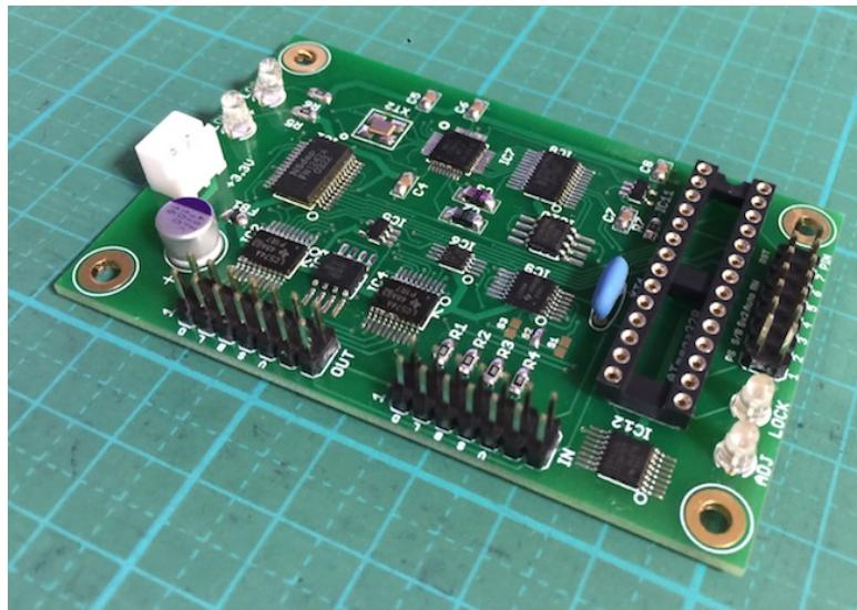
この基板は、FN1242A DACチップを使ってI2S信号(PCM)をDSD信号に変換 (P2D)して出力します。
