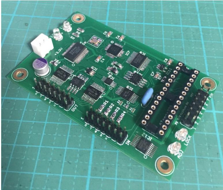
この基板は、FN1242A DACチップを使ってI2S信号(PCM)をDSD信号に変換 (P2D)して出力します。
