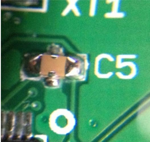
3端子コンデンサは、GND部分のハンダ付けが難しいので最初の方（FB1の後）でハンダ付けしましょう。
