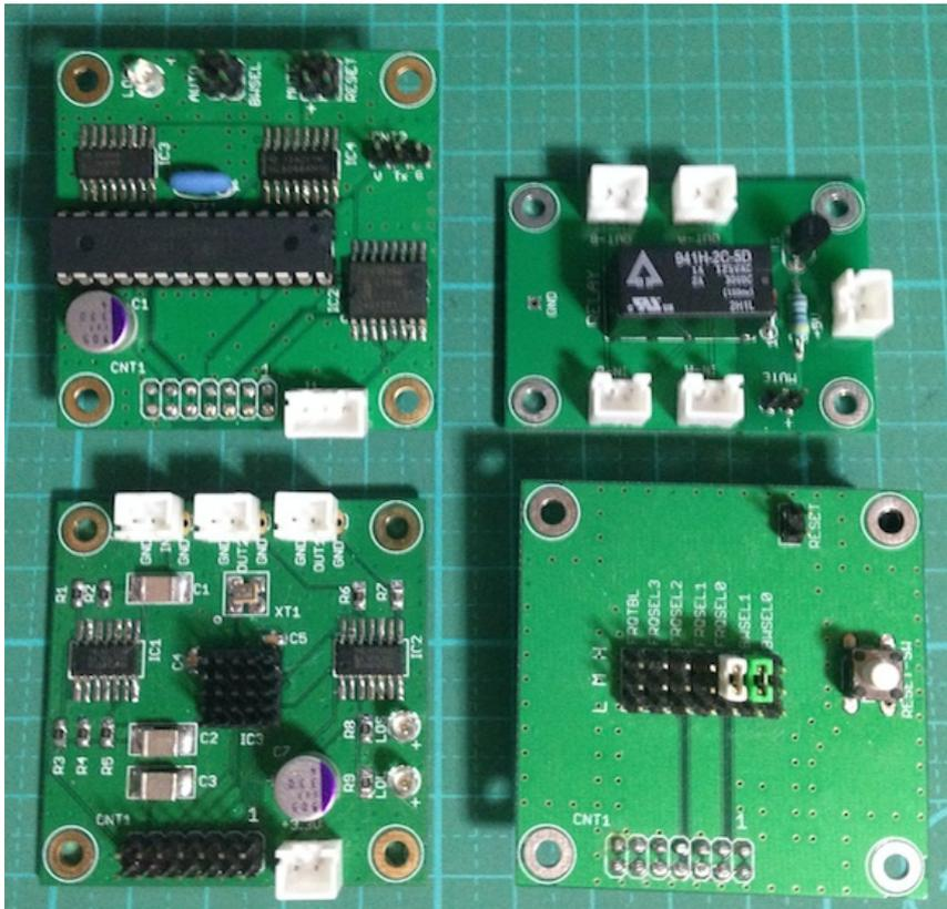
この基板は、CDトランスポート等のBCLKやSCLKに含まれるジッターを減らすことが出来ます。入力周波数を自動判別して、Si5317の周波数テーブルの設定を行います。更に入力と出力のクロックのSi5317による位相差も自動修正します。設定から位相差自動修正までは、出力クロックが入力クロックとズれるのでノイズが出ますが、その間はミュート信号を出力しますので、DACの出力にリレーを使ったミュート回路を追加すれば、ノイズカットも出来ます。ジッタークリーナーの対象周波数は、1MHz~100MHzです。
