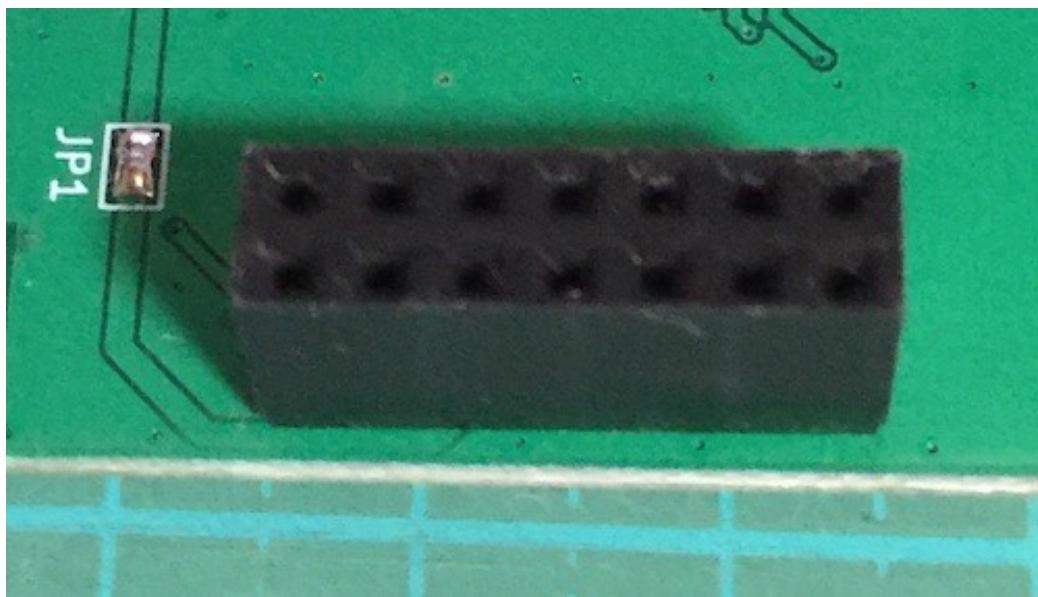
2) 14ピンフラットケーブルで接続する場合は、2X7ピンヘッダを表面に付けます。
