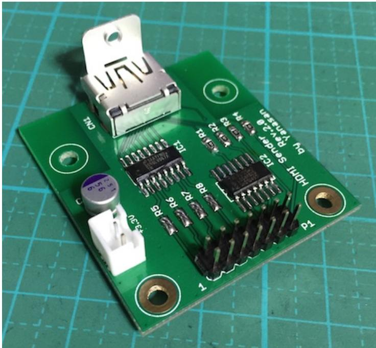
この基板は、I2S信号をLVDSでHDMIケーブルを使って送信します。
