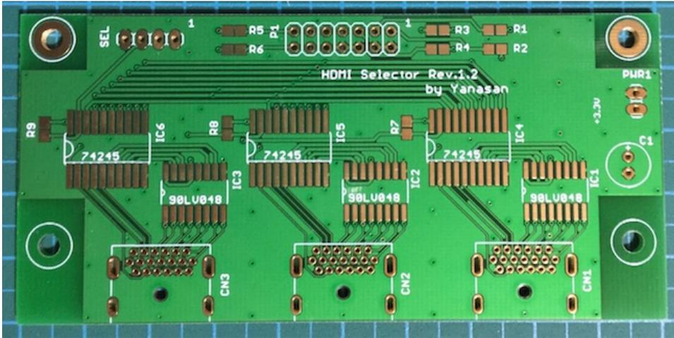
HDMI-I2Sセレクター基板の裏面
