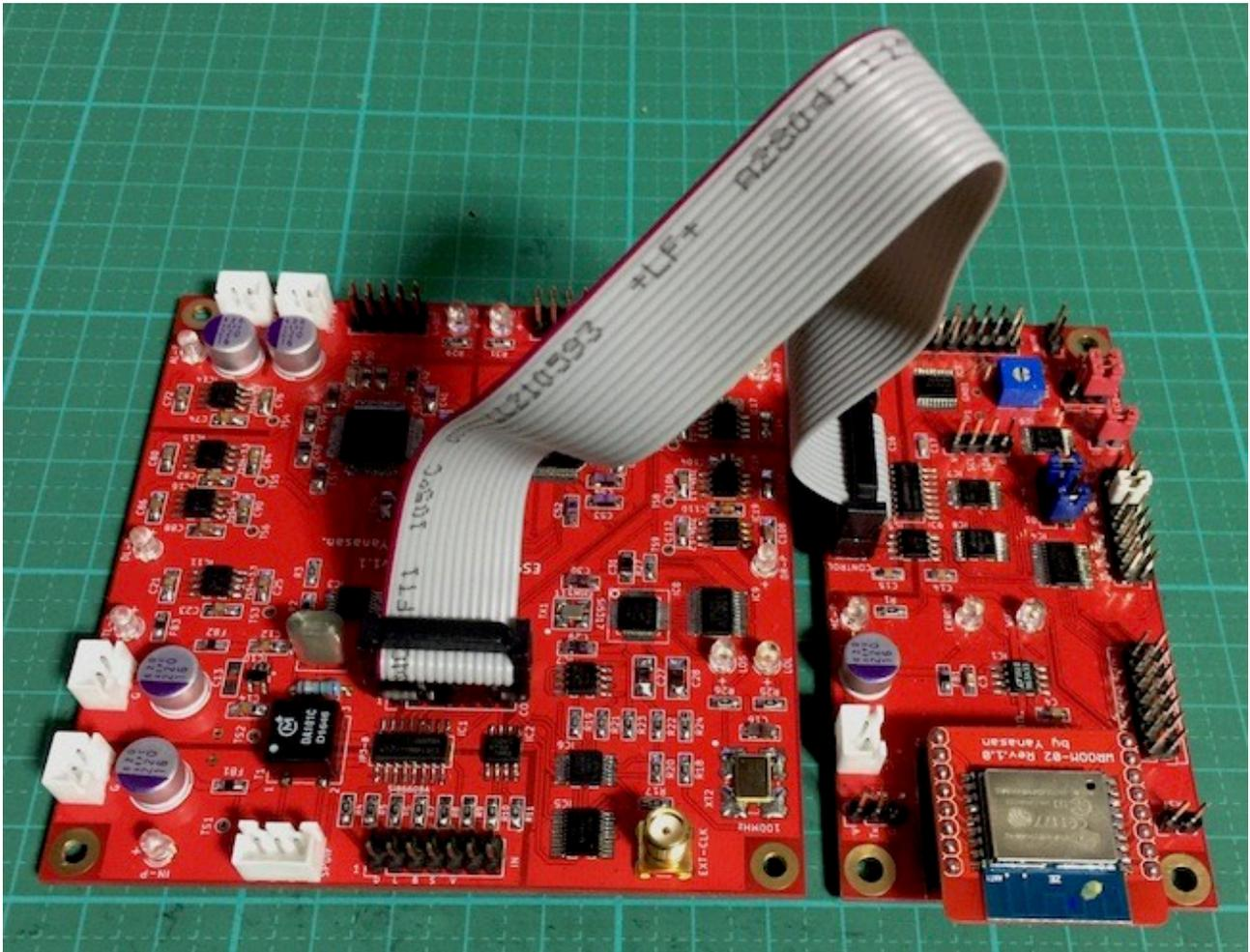
コントローラ1基板とDAC基板のCONTROLコネクタを7×2ピンのフラットケーブルで接続する。
