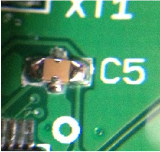
3端子コンデンサは、GND部分のハンダ付けが難しいので最初の方（FB1,FB2の後）でハンダ付けしましょう。
