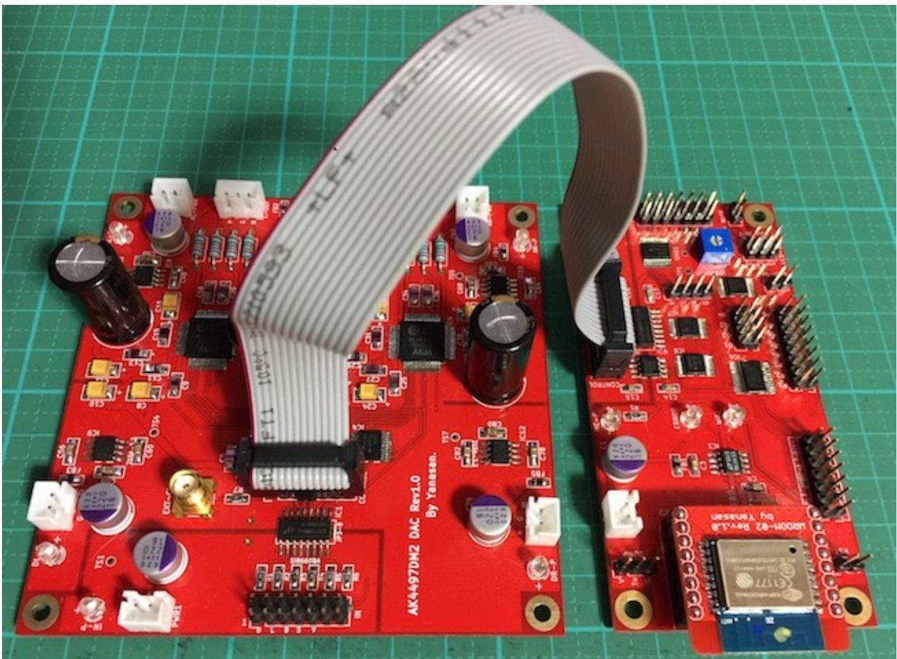
コントローラ1基板とDAC基板のCONTROLコネクタを7×2ピンのフラットケーブルで接続する。
