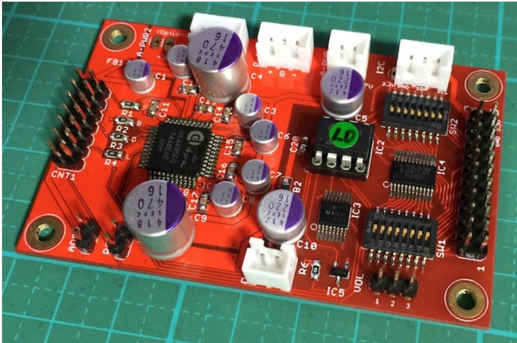
この基板は、旭化成のAK4495EQ DACチップを使って、I2S信号(PCM、DSD)をアナログ信号に変換します。
