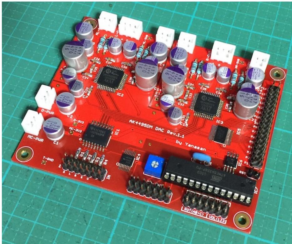
この基板は、旭化成のAK4495EQ DACチップを使って、I2S信号(PCM、DSD)をアナログ信号に変換して、デュアルモノ再生が出来ます。
