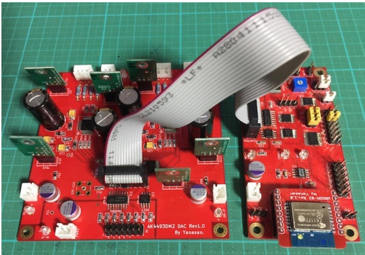
コントローラ1基板とDAC基板のCONTROLコネクタを7×2ピンのフラットケーブルで接続する。
