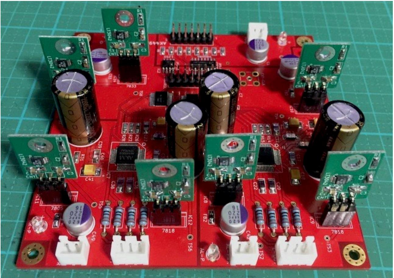
※基板側に3ピンソケットを使って、3端子レギュレータ基板を刺しています。
